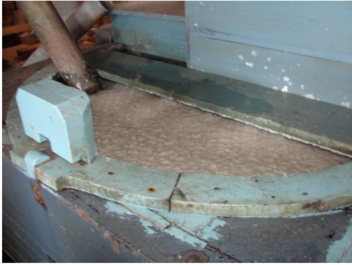
9 La cuve de la pile hollandaise
